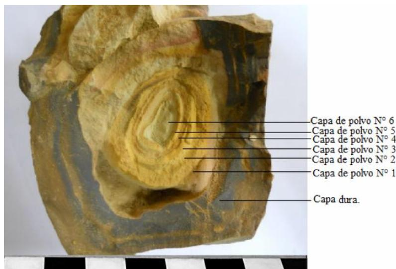
Figura N° 1 - Corte transversal del Machu rumi, donde se aprecia las 6 capas.
